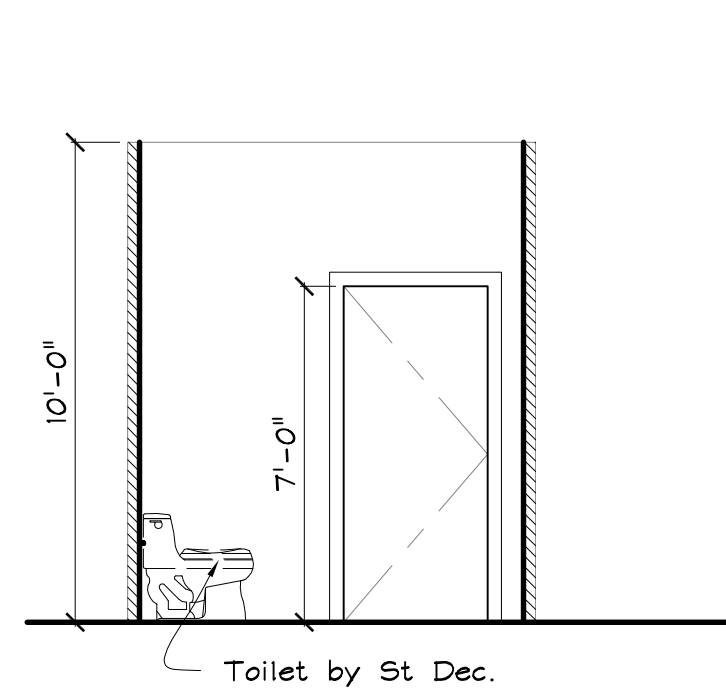
Dorm Bath Elevation 17 Scale: 1/4" = 1'-0"
